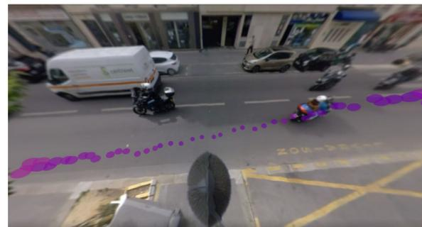
Visualisation de la trace acoustique générée par le passage d'un véhicule deux-roues motorisé
