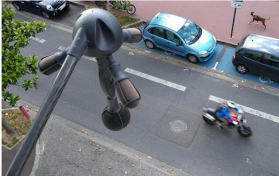
Cette multiplicité de microphones permet de détecter de petits décalages temporels lors de l'arrivée du son, qui sont suffisants pour permettre de reconstituer dix fois par seconde la direction du bruit dominant. Cette direction est évaluée par l'intermédiaire des deux angles dits d'azimut et d'élévation.
